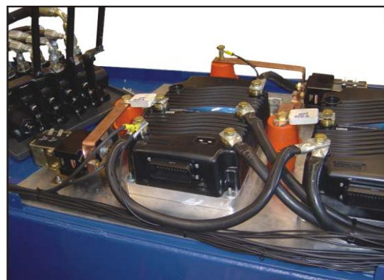
Controladores eletrônicos Curtis (Corrente Alternada) e comando hidráulico Sauer Danfoss.
