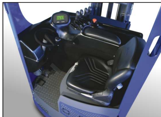
Célula do operador com controles gerais e display digital Curtis em cristal líquido.
